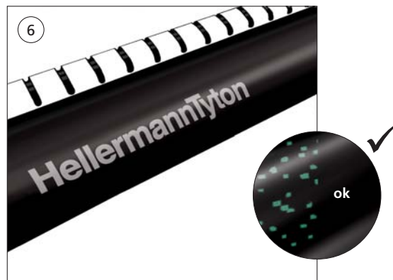
Para certificar-se se a manga retraiu na totalidade confirme se os pontos de pintura termo cromática desapareceram e se é visível adesivo nas duas extremidades da manga.
