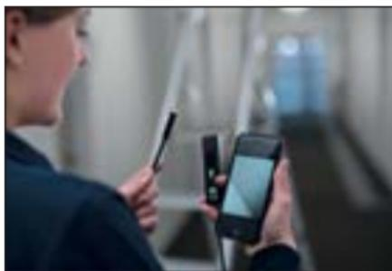
La cámara Cable Scout Cam está pensada principalmente para la inspección visual en conductos, falsos techos, paredes modulares y conductos de aire. HellermannTyton no recomienda el uso este producto en situaciones donde pueda estar sumergido en líquidos. En el caso de usarse en zonas dónde la humedad esté presente, deberá protegerse el objetivo de la cámara con el protector frontal del objetivo.
