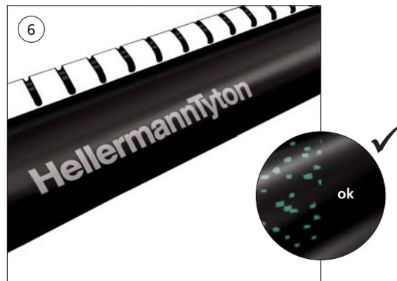
Para determinar si el manguito ha sido completamente contraído, especialmente en la parte trasera del manguito, chequee si todos los puntos TCP han desaparecido y algo del adhesivo fluye saliendo por los extremos.
