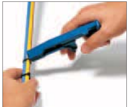
Corte, girando la herramienta.
