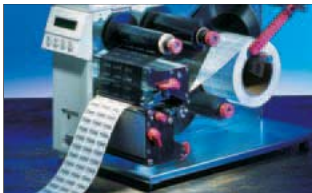
Aplicación de cintas de impresión en impresoras de termotransferencia.
