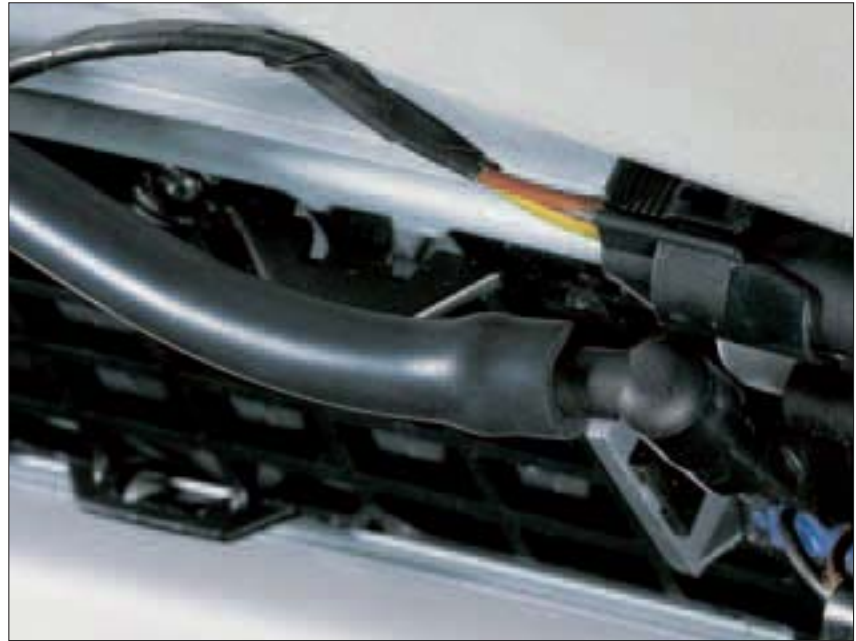
Tubo EPDM para sistemas de limpiaparabrisas en automóviles.
