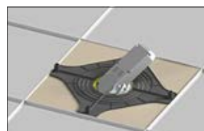
3. Inserte el downlight dentro del agujero cortado.
