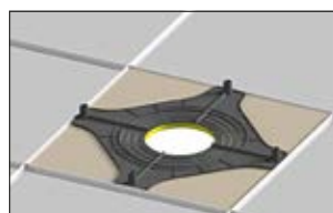
2. Corte la placa de techo.
